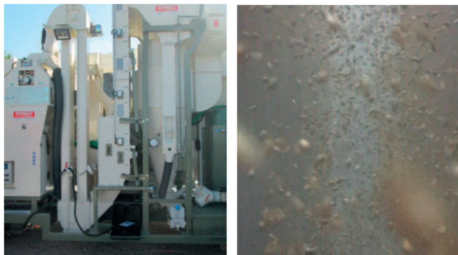
Денсиметричний підсос повітря, суттєво покращує якість очищення насіння від пилу та легких домішок
