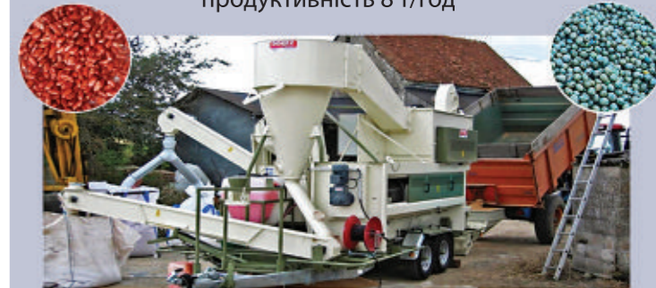
Вертикальний Entgranner(De-Awner) і результат його роботи
