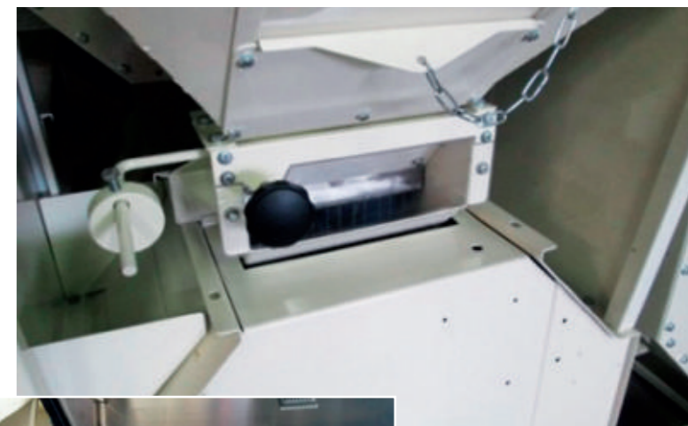
Внесення робочої рідини по всій ширині змішувача в протруєнику STB7/STB12
